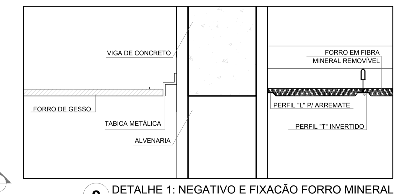
2 DETALHE 1: NEGATIVO E FIXAÇÃO FORRO MINERAL ESCALA 1/5
